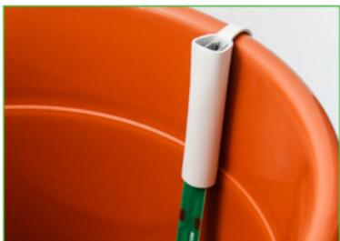
Fijar el soporte de la sonda de nivel al borde superior del depósito base, de modo que la sonda quede en el interior del depósito. (EG10.PLUS)
